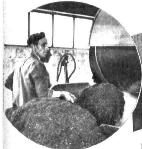
**7** Después del picado, el tabaco pasa a los torrefactores, para ser secado.
